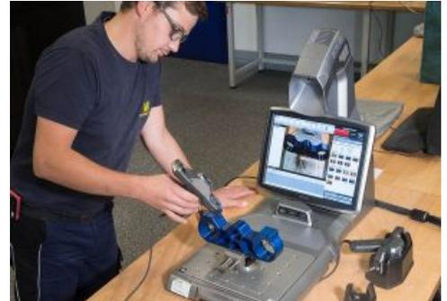
*Keyence 3D-Koordinatenmessgerät mit einer Wiederholgenauigkeit von  $\pm 3 \mu\text{m}$*
