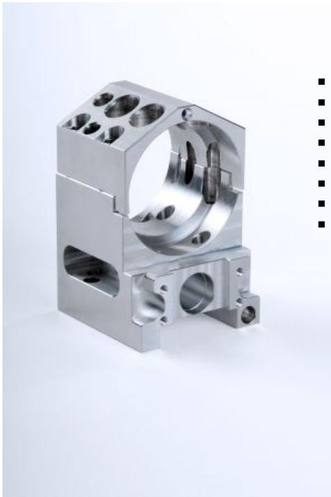
*Frästeile montiert zu einer Baugruppe*
